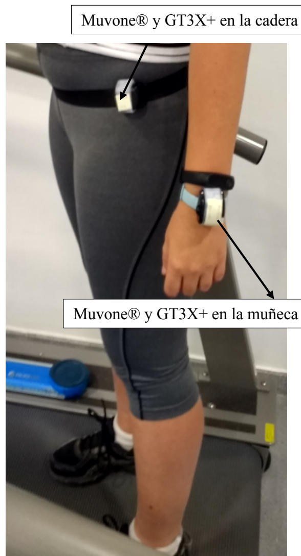
Figura 1. Acelerómetros Muvone® y GT3X+ adyacentes y pegados, colocados sobre la cadera y la muñeca no dominantes.
